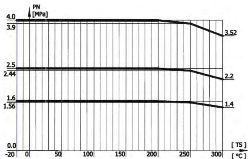
Wykres A30. Wykres zależności między dopuszczalnym ciśnieniem roboczym i dopuszczalną temperaturą roboczą kurków kulowych DZT / BALLOMAX / ARMATURA AH-30, do sieci ciepłowniczych parowych SSP 10-50
